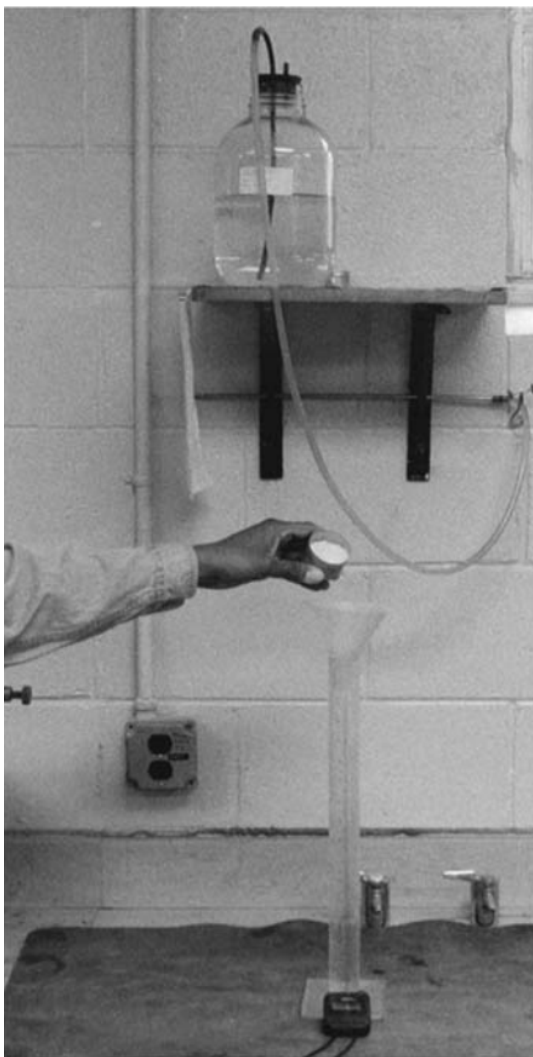
Hình 4 - Đổ mẫu từ ống đong qua phễu vào ống thử
