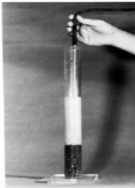
Hình 6 - Phun dung dịch vào ống thử có chứa mẫu
